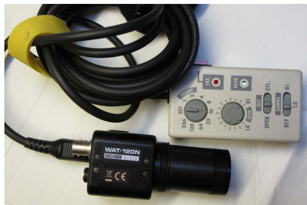
De oude bekende Watec 120 camera, analoog en met al lang goed bekende interne tijdvertraging. De camera is nog steeds net zo lichtgevoelig als de meest recente digitale concurrenten.
