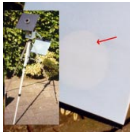
fig 5: De projectie apparatuur (een omgebouwd landmeetkundig instrument)
